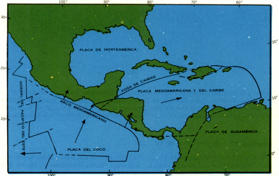
Fig. 2 Tectónica de placas de América Central. El Arco Mesoamericano es el cinturón Centroamericano de volcanes y terremotos que demuestra la sumersión de la Placa del Coco debajo de la Placa Mesoamericana y del Caribe. La primera proviene del Suroeste del Dorsal del Pacífico del Este (según Molnar y Sykes, 1969).
